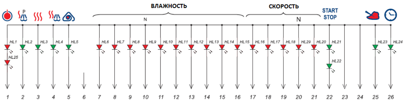
Схема электрическая соединения светодиодов
